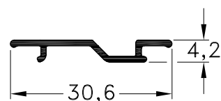
1040129 - Tapa Doble Compensador Peso: 0,12 Kg/m. Largo Std.: 6.030 mm.
